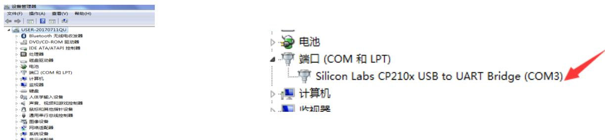
6.联机软件安装成功，可以联机操作了，联机时加密狗不能拔掉一直要插在电脑主机上，结束方可拔掉
